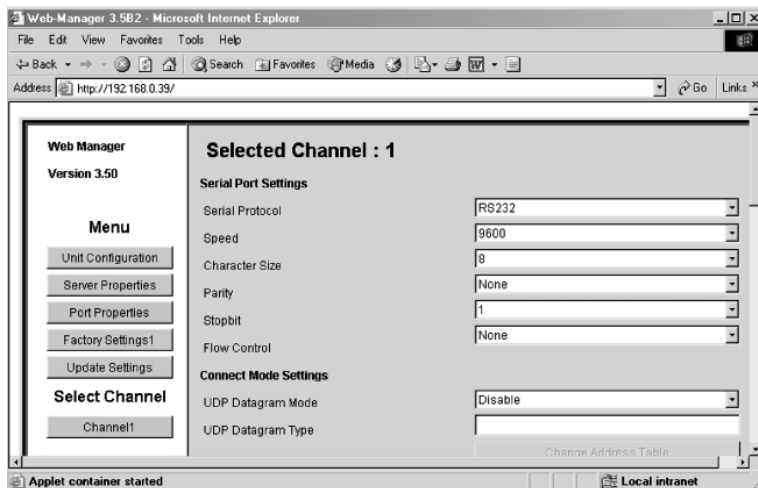
Рис. 11. Веб-менеджер настройки порта Ethernet коммутатора
